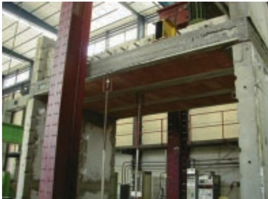
Ensayo mecánico de panel estructural para cerramiento
