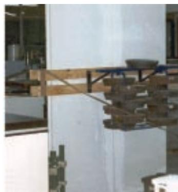
Ensayo de carga excéntrica sobre partición
