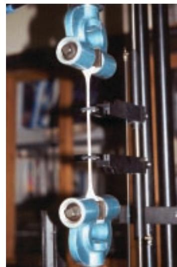
Ensayo de tracción. Instrumentación
