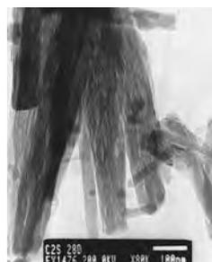
Fig.2: Aspecto fibroso del gel CSH en una muestra de C2S, a 28 días de hidratación (TEM/EDX)
