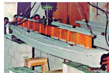
Ensayo de flexión en placa
