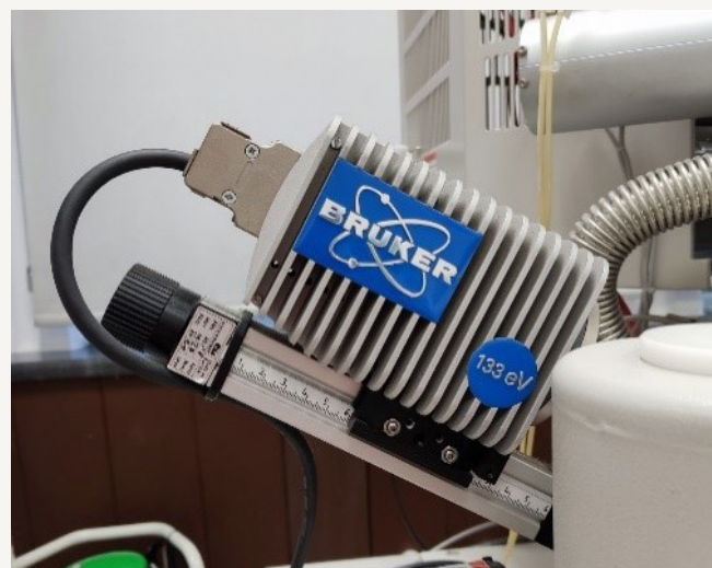
Detalle del detector elemental de microanálisis
