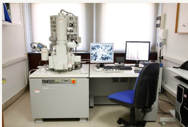
Microscopio electrónico con detectores de SEM, BSE y EDX
