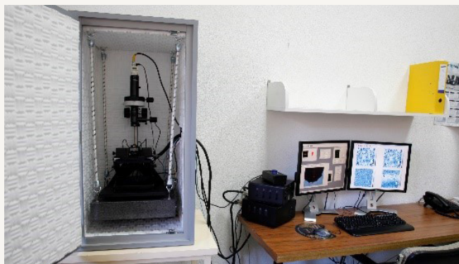
Microscopía de fuerzas atómicas con la imagen tomada a la derecha
