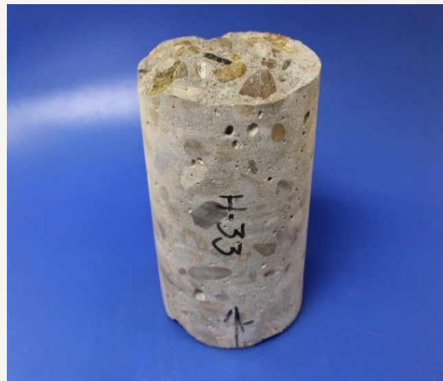
Testigo de hormigón
