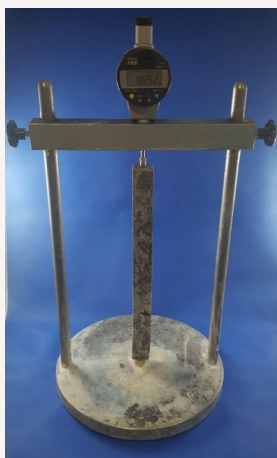
Distintas geometrías de probetas para ensayos de expansión
