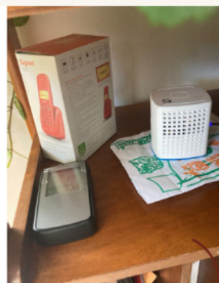
Toma de datos puntuales de radón/VOCs/ formaldehído
