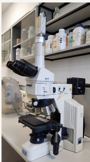
Microscopio óptico con cámara para captación de imágenes
