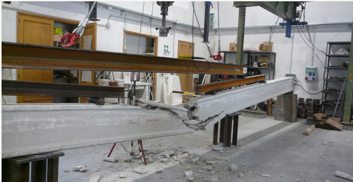
Ensayo de flexión positiva de viga tubular de hormigón pretensado
