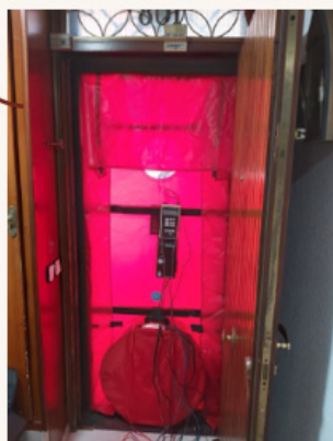
Ensayo de estanqueidad Blower Door
