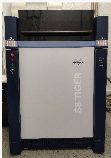
Equipo de fluorescencia de rayos X
