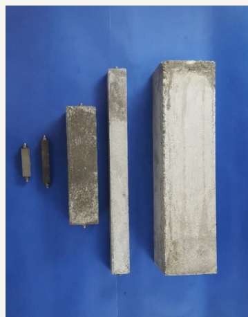
Distintas geometrías de probetas para ensayos de expansión
