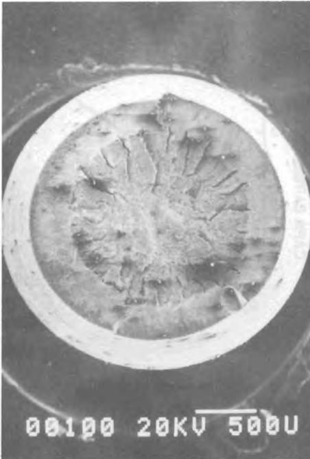
Figura I.15.a.—Rotura dúctil de un acero de pretensado.
