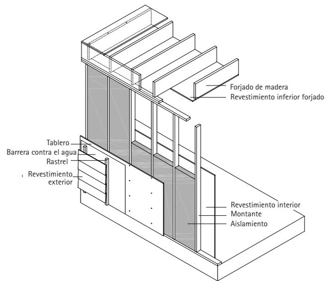
Figura 0.2. Edificación con sistema de entramado pesado
