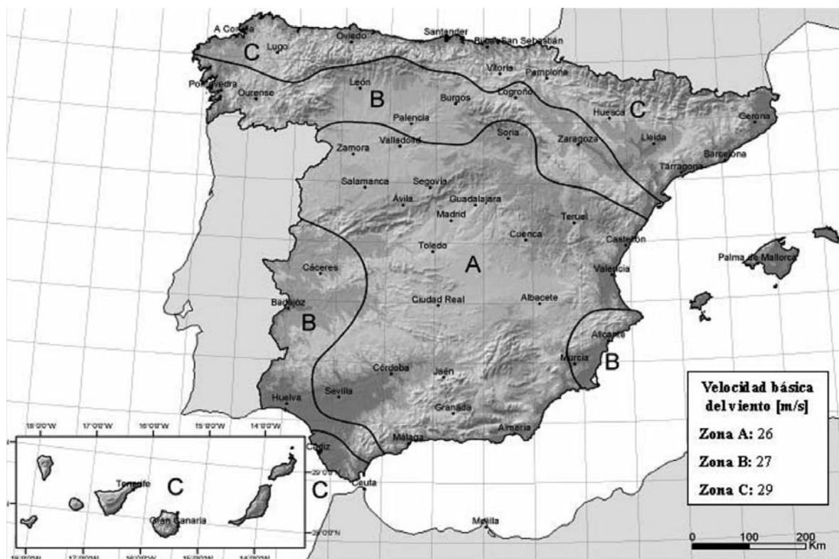
Con el grado de exposición al viento obtenido y la zona pluviométrica de promedios obtenida en el mapa de la Figura 0.14, en la Tabla 0.31. se obtiene el grado de impermeabilidad exigido para fachadas, que puede variar entre 1 y 5.
