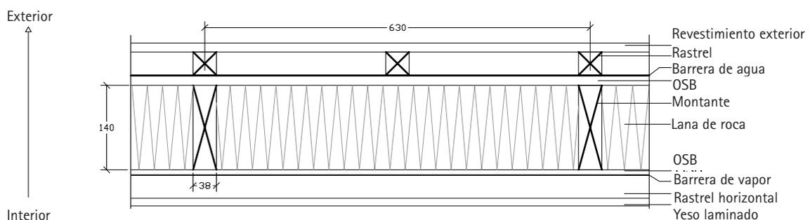
Figura B.3: Vista en planta de la solución constructiva de tabiques (cotas en mm)
