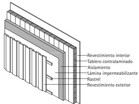
Figura 0.4. Edificación con muros de bloques de madera
