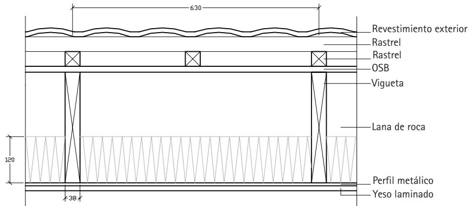
El espesor mínimo requerido de lana mineral en el forjado es de 110mm. Para que cumpla los requerimientos acústicos, el espesor empleado será de 120 mm.
