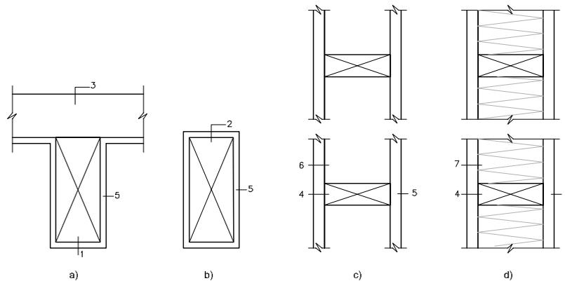
1 viga, 2 pilar, 3 forjado, 4 montante o vigueta, 5 revestimiento o cerramiento, 6 cavidad hueca, 7 cavidad llena de aislante térmico.
