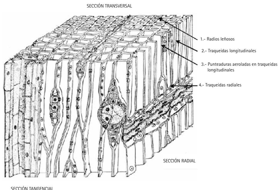
Figura 0.5. Vista tridimensional de un corte anatómico de la madera de conífera
