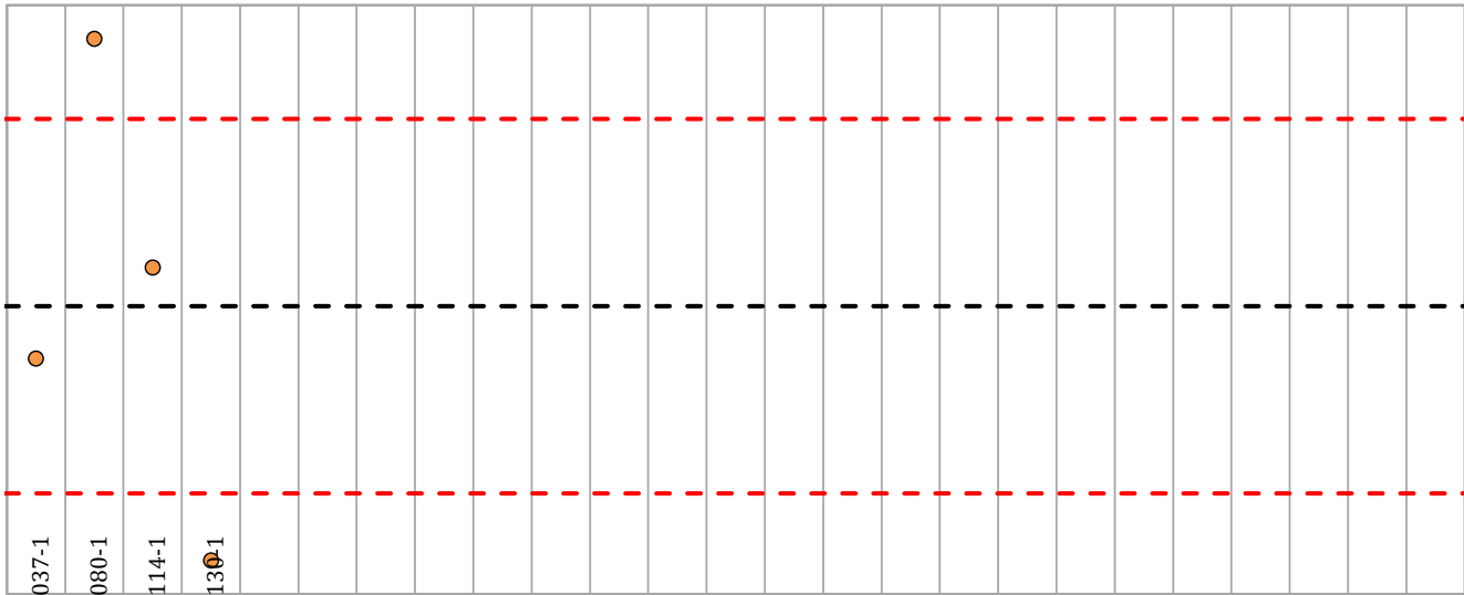
Gráfico 01. Diagrama XY Dispersión de la media de cálculo según norma de ensayo ( m_{Arit} ). La línea de color negro marca el valor promedio y las de color rojo el promedio más/menos la desviación estandar respecto de la media.
