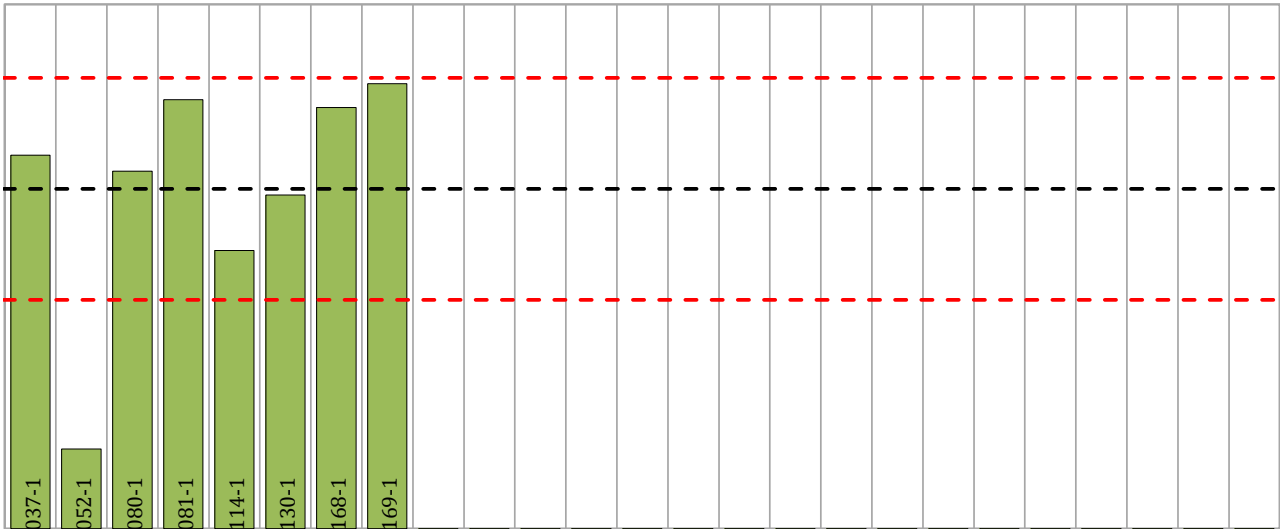
Gráfico 02 . Diagrama de Barras Dispersas de la media de cálculo según norma de ensayo ( m_{Arit} ). La línea de color negro marca el valor promedio y las de color rojo el promedio más/menos la desviación estandard respecto de la media.
