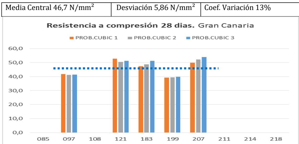
**b. ESTUDIO PRELIMINAR RESULTADOS RESISTENCIA A COMPRESIÓN A 28 DÍAS: PROBETAS CILÍNDRICAS**
