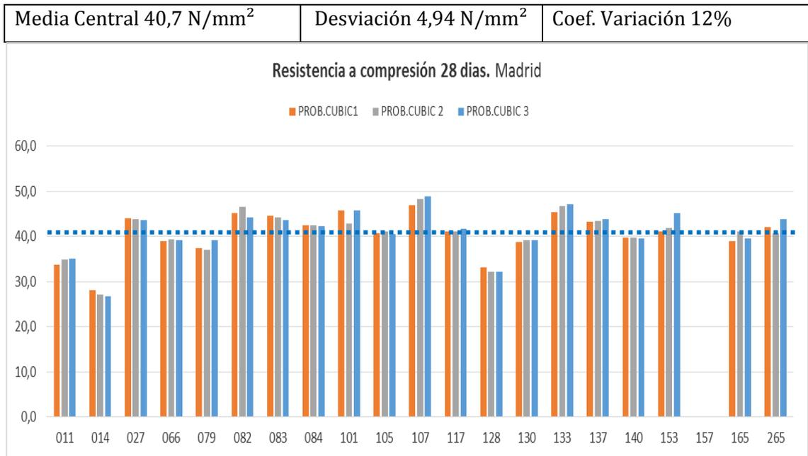
**b. ESTUDIO PRELIMINAR RESULTADOS RESISTENCIA A COMPRESIÓN A 28 DÍAS: PROBETAS CILÍNDRICAS**
