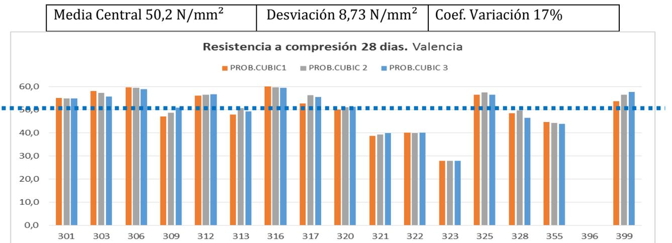
**b. ESTUDIO PRELIMINAR RESULTADOS RESISTENCIA A COMPRESIÓN A 28 DÍAS: PROBETAS CILÍNDRICAS**
