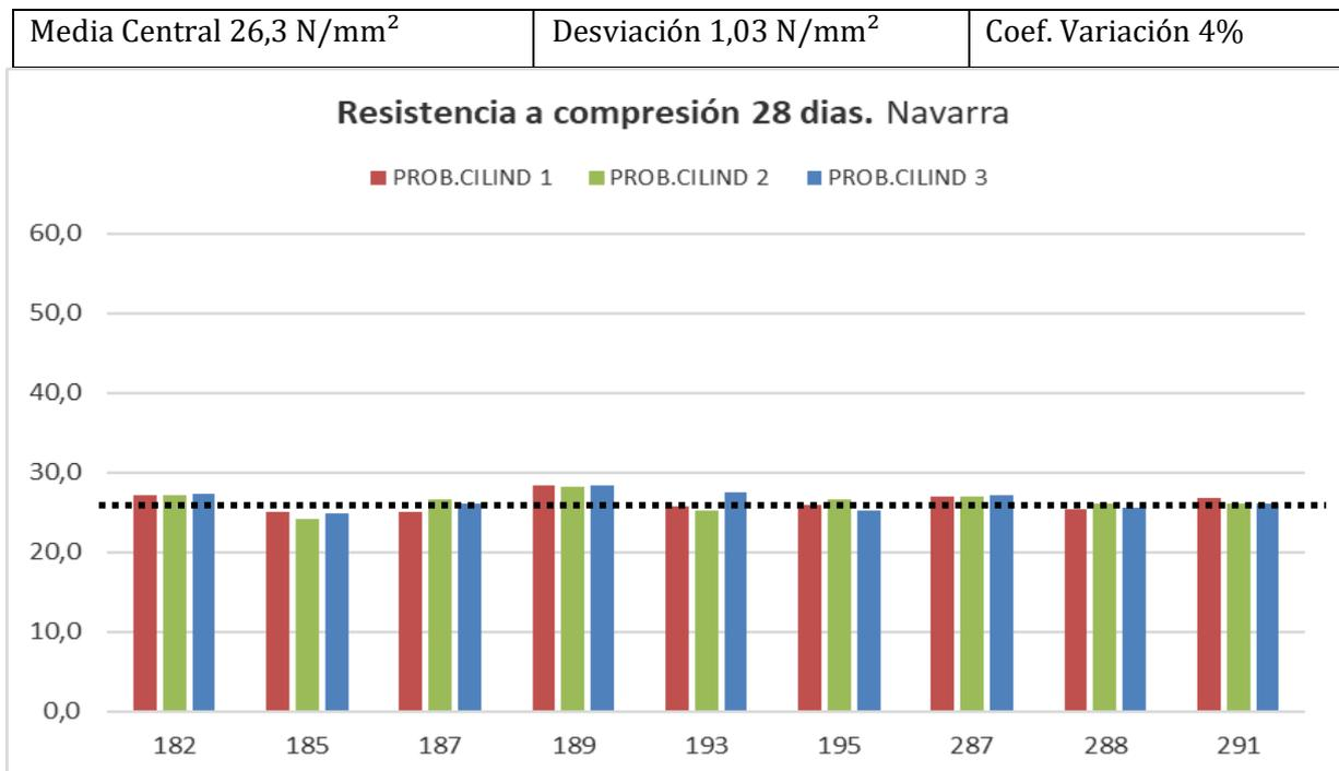
**c. ESTUDIO PRELIMINAR RESULTADOS RESISTENCIA A COMPRESIÓN A 28 DÍAS: PROBETAS CÚBICAS**
