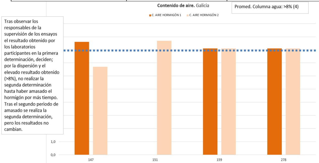
Por falta de un número suficiente de resultados precisos en los ensayos de contenido de aire **no se puede analizar estadísticamente.**
