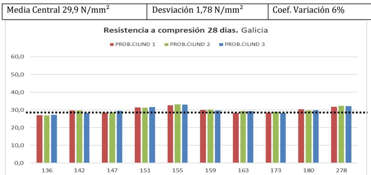
**c. ESTUDIO PRELIMINAR RESULTADOS RESISTENCIA A COMPRESIÓN A 28 DÍAS: PROBETAS CÚBICAS**
