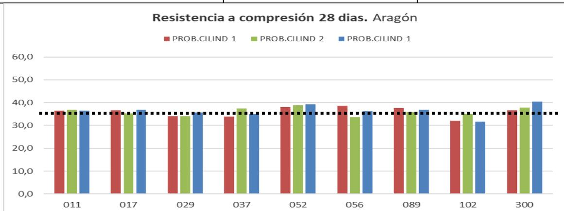
**c. ESTUDIO PRELIMINAR RESULTADOS RESISTENCIA A COMPRESIÓN A 28 DÍAS: PROBETAS CÚBICAS**
