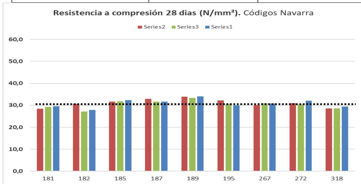
**c. ESTUDIO PRELIMINAR RESULTADOS RESISTENCIA A COMPRESIÓN A 28 DÍAS: PROBETAS CÚBICAS**
